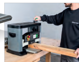
Höheneinstellung über Handkurbel und Skala
