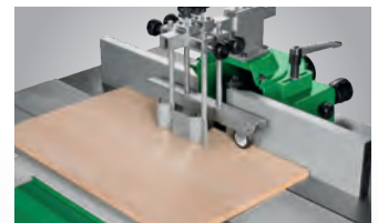
Fräsanschlag mit feineinstellbaren Aluminium-Anschlägen
