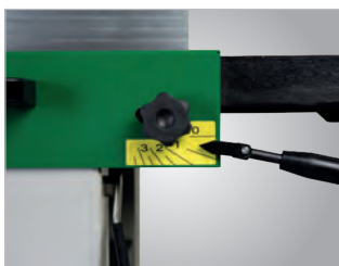
Verstellung der Spanabnahme über Bedienhebel
