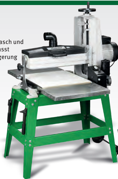
Höhenverstellung der Schleifeinheit an einer Skala ablesbar
