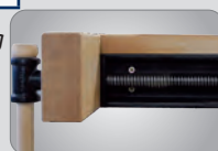
Fingerverzinkung in Hinterzange und Beiladerücken
