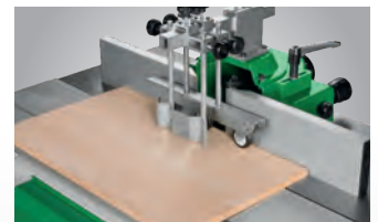
Fräsanschlag mit feineinstellbaren Aluminium-Anschlägen
