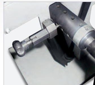
Reihenbohrungen durch Dübelbohrereinrichtung mit Rasterteilung 16/22/25/32 mm möglich
