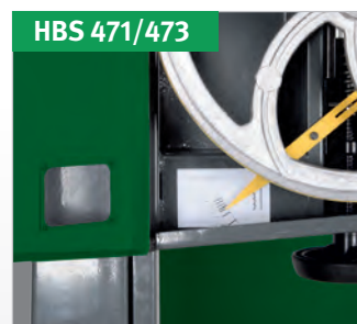
HBS 471/473 Die Sägebandschneidung ist von außen durch ein in der Tür integriertes Sichtfenster ablesbar
