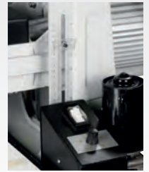
Höhenverstellung der Schleifeinheit an einer Skala ablesbar
