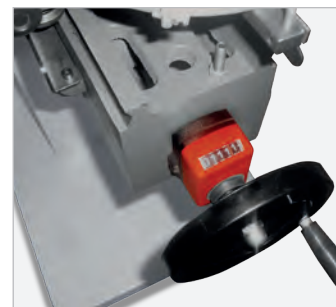
Bequeme, exakte Tischhöhenverstellung über ein Handrad mit numerischer Anzeige
