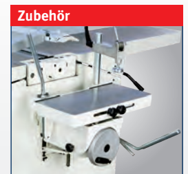
Langlochbohrereinrichtung in Guss-Ausführung Art.-Nr.: 5514500
