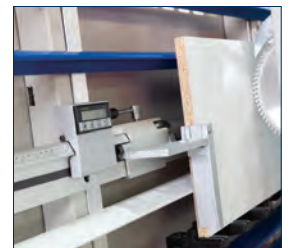
• Digitale Maßanzeige zur Längeneinstellung beim Vertikalschnitt
