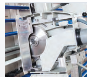
• Große Öffnung für Sägeblattwechsel
