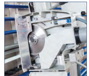
• Große Öffnung für Sägeblattwechsel
