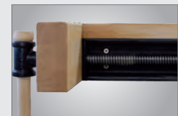
Massive Linearführung an der Hinterzange
