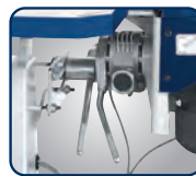
Schleifaggregat über Hebel bis 45° schwenkbar
