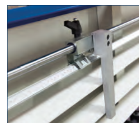
• Lineal zur Längeneinstellung beim Vertikalschnitt
