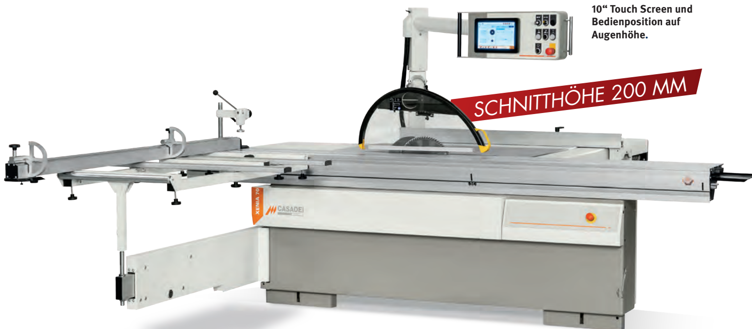
Abbildung zeigt Option elektronisch positionierbaren Parallelschlag
