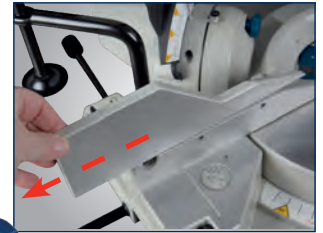
Ausziehbare Anschlagsschienen und ausziehbarer Tisch
