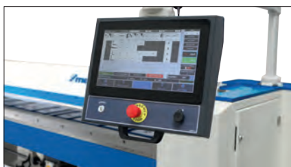
Bedienerfreundliche 15,6“ Touchscreen NC-Steuerung an ergonomischen Schwenkarm
