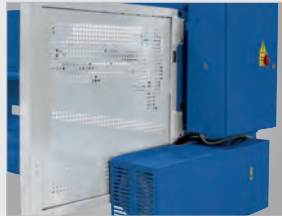
▶ Rückraumsicherung nach CE mit Seitenblechen und Lichtschanke
