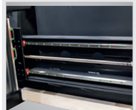
▶ Die über Kugelumlaufspindeln angetriebene X-Achse läuft auf doppelter Linearführung
