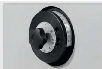
serienmäßige Steuerung MA – manuelle Verstellung des Biegewinkels mittels Skalerring an der linken Maschinenseite
