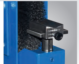
▶ Mit verstellbarer Prismen Werkstückauflage
