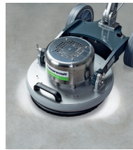
▶ Aufarbeiten und Schleifen von Estrichböden
