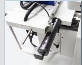
• Dübelbohrereinrichtung mit Rasterteilung 16 / 22 / 25 / 32
