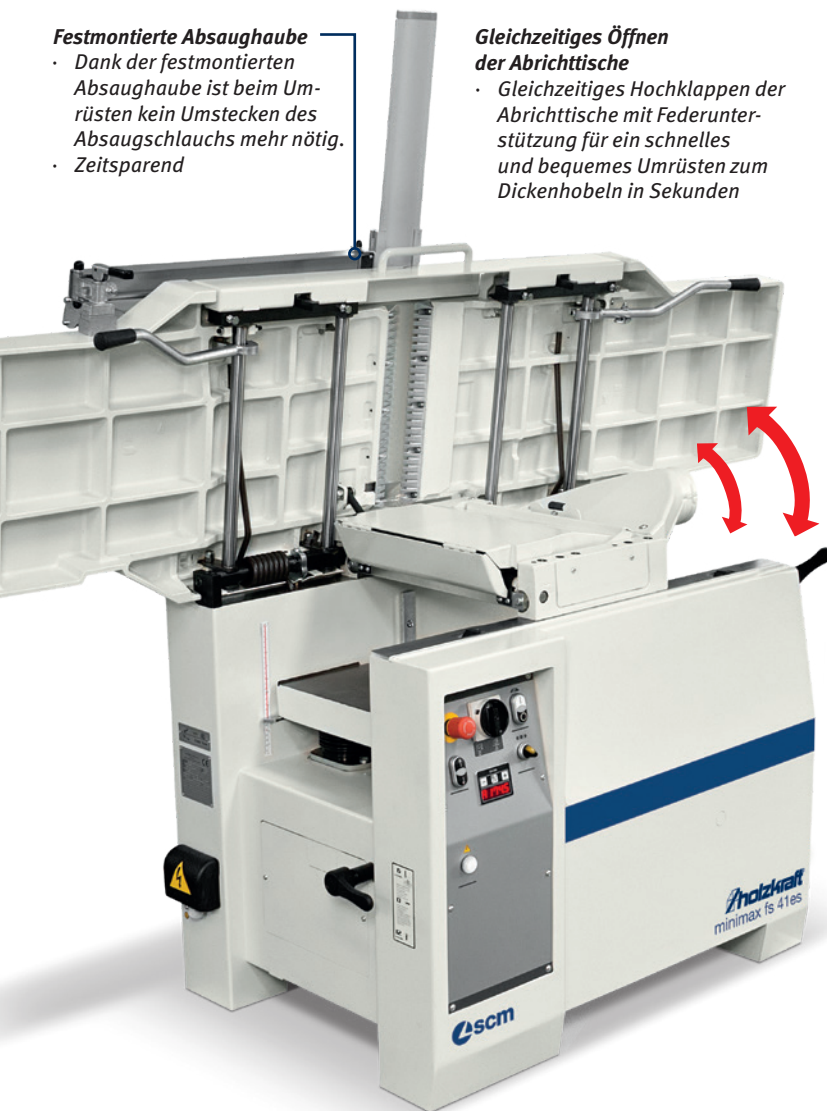
minimax fs 41es TERSA digital mit motorischer Höhenverstellung und Digitalanzeige
