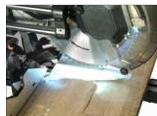
Extrem genaue Lichtprojektion der Schnittkante
