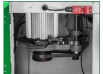
Schnelles und einfaches Wechseln der Drehzahl mittels Vielkeilriemen
