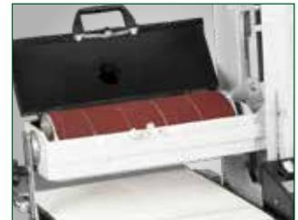
Einfacher und schneller Schleifbandwechsel
