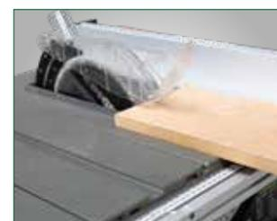
Klappbarer Parallelanschlag für dünne Werkstücke
