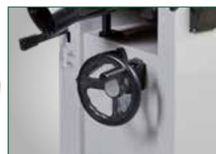
Dickentischverstellung über Handrad, Skala und numerischer Anzeige
