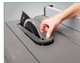
Werkzeugloser Wechsel der Sägeblattschutzhaube und der Tischeinlage
