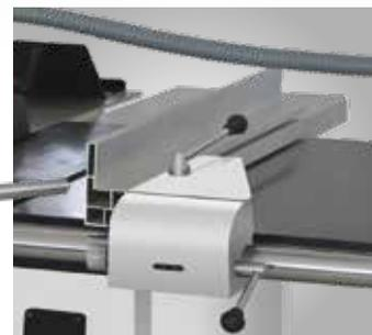
Großer Aluminium-Parallelanschlag auf Rundstangenführung mit Feineinstellung
