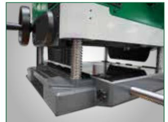
Höchste Präzision durch massive Vierfach-Spindelführung des Hobelaggregats
