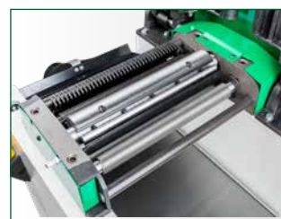
Hobelaggregat mit Streifenhobelmessersatz
