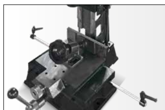
Beweglicher Spannbacken mit Schnellspannfunktion
