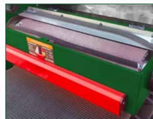
Massive Stahlwalze und verbauter Sicherheitsschalter an der Einzugsseite
