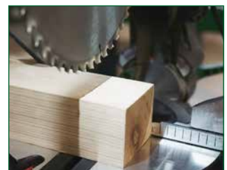
Extrem genaue Lichtprojektion der Schnittkante
