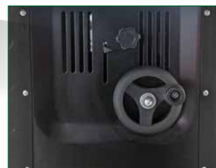
Spindelhöhe von 0 bis 40 mm einstellbar
