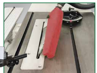
Sägeblattschwenkung von 90° bis -45° nach rechts
