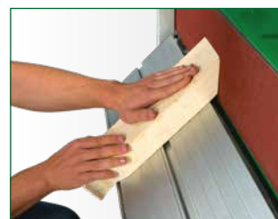
Gehrungen bis 45° durch Schwenken des Längstisches
