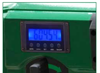
DH 330-2 Spiral: Digitale Anzeige der Hobelhöhe
