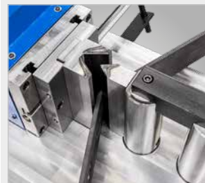
► Mit Schnellwechselaufnahme und Seitenanschlag mit Skala
