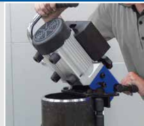
Entgraten von Rohren möglich
