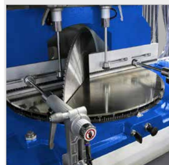
▶ Stufenlose Verstellung des Gehrungswinkels
