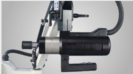
▶ Maschinenkopf von 0 bis 90 Grad schwenkbar
