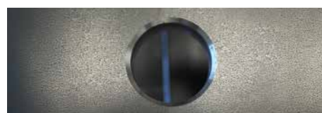
Bohrung mit Fase (nachher)
