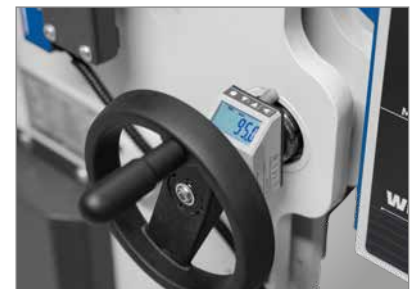
Verstellung des Hinteranschlags über Handrad mit Zählwerk
