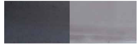
▶ Abb.: Edelstahl links roh, rechts geschliffen mit MBSM 2505 ESE, eingesetztes Schleifband K 120 zur Oberflächenstrukturierung
