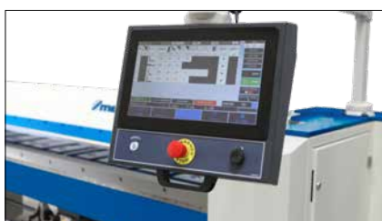
Bedienerfreundliche 15,6" Touchscreen NC-Steuerung an ergonomischen Schwenkarm
