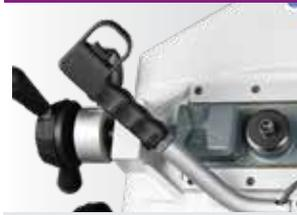
> Manueller Sägebandlauf - am Handhebel schaltet den Lauf des Sägebandes ein und aus
