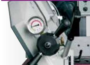
> Einfache und richtige Einstellung der Sägebandspannung mittels Manometer
