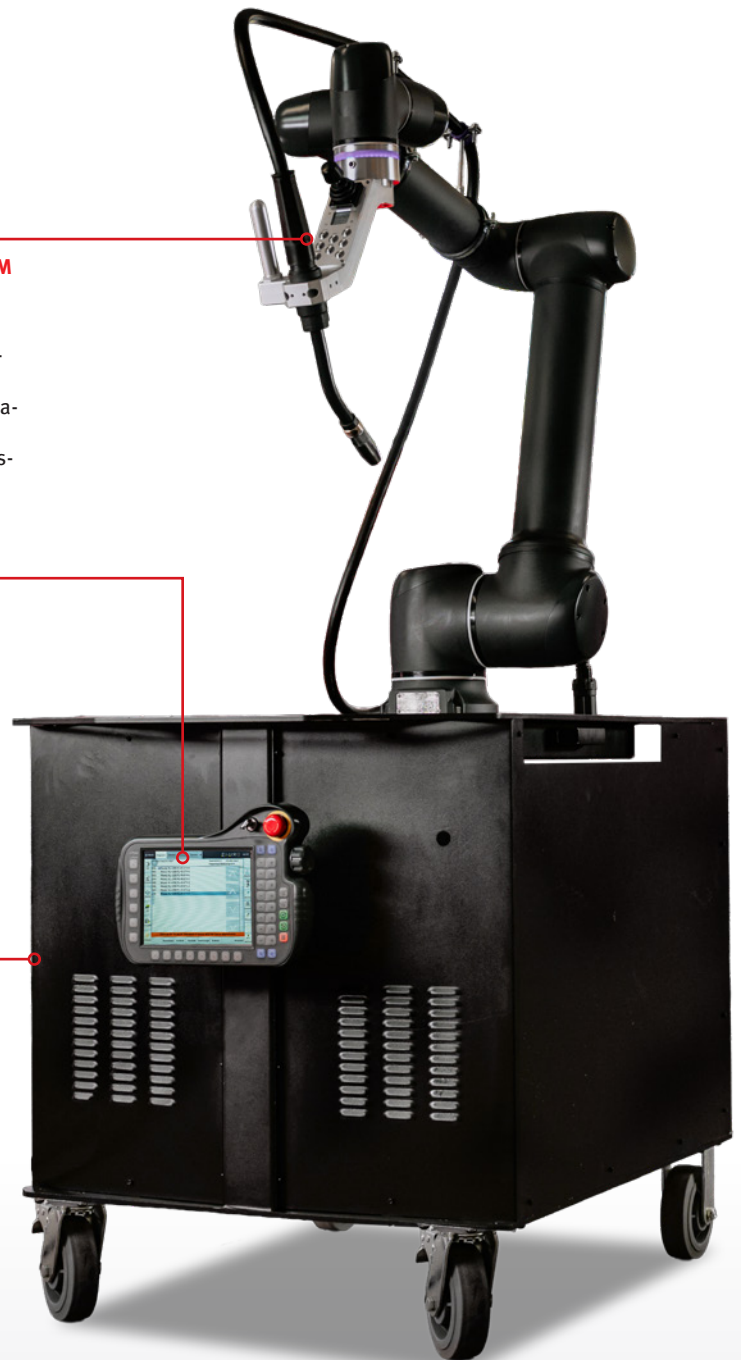
Craft-Cobot 1.3 MIG LowSpatter mit optionalem Unterbau
