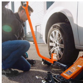
für das Justieren des Rades zur Radnabe und den Transport
